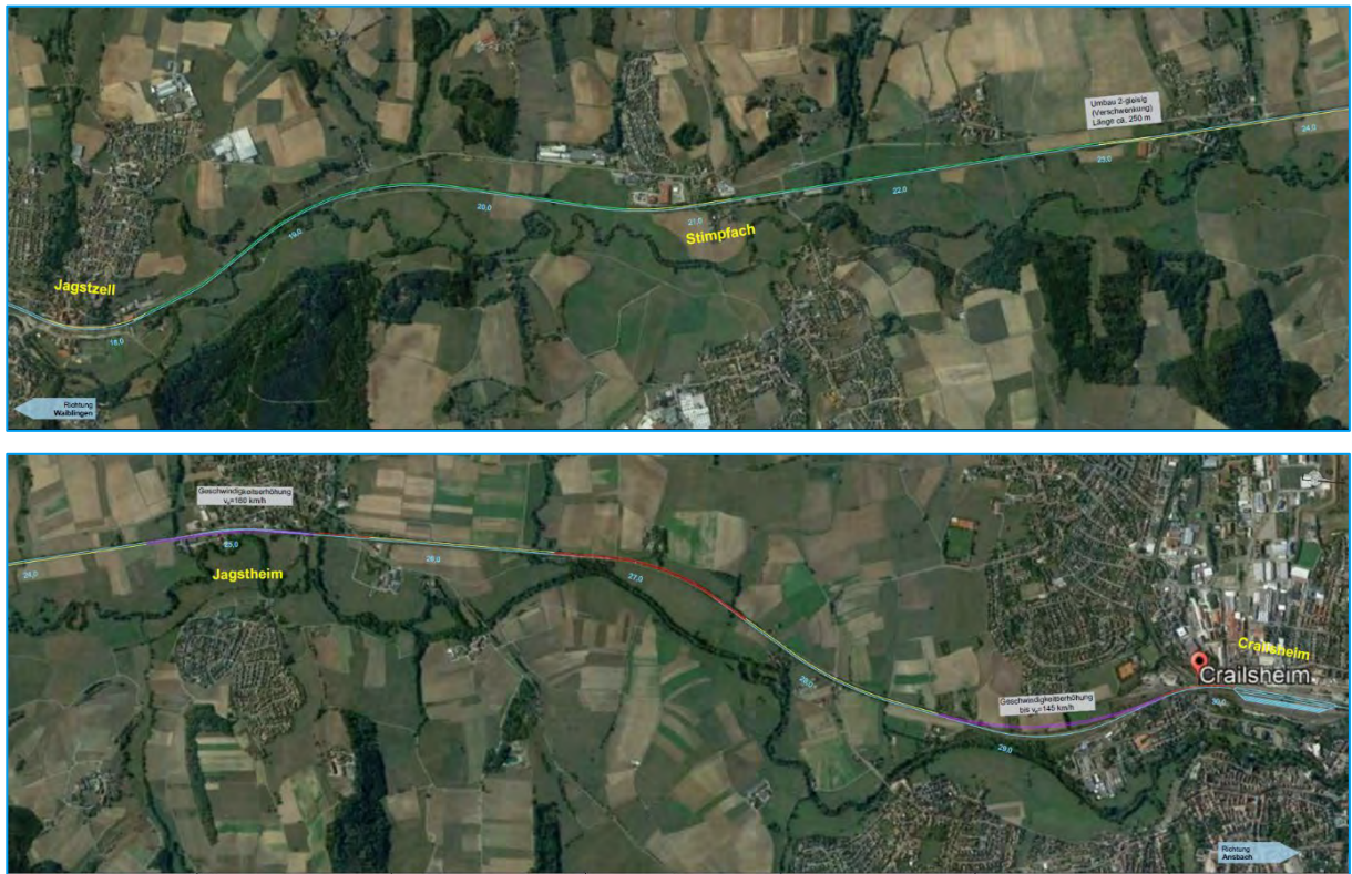
Abbildung 76: Zweigleisiger Ausbau Jagstzell – Crailsheim auf 160 km/h
