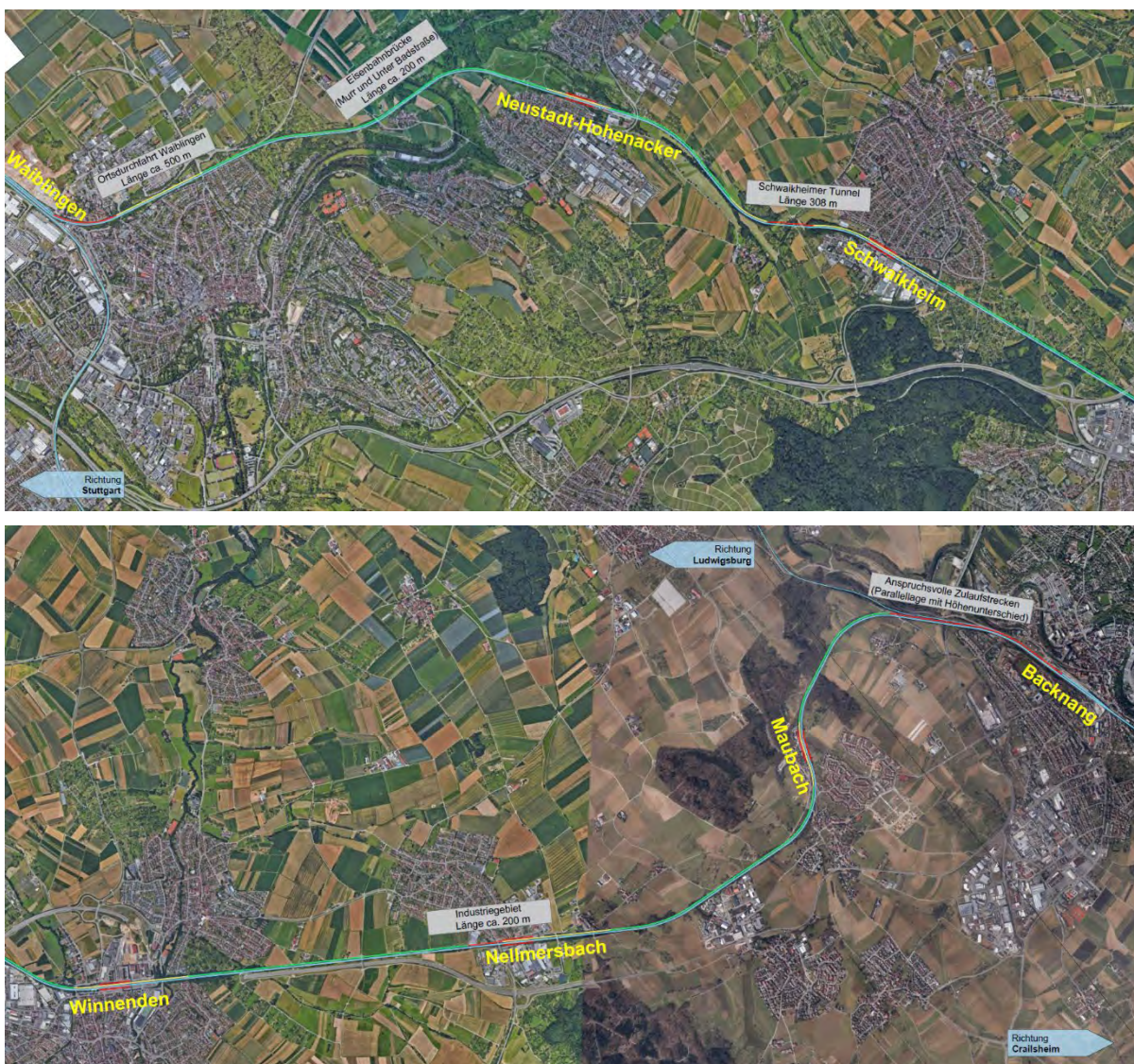
Abbildung 86: Viergleisiger Ausbau Waiblingen – Backnang
